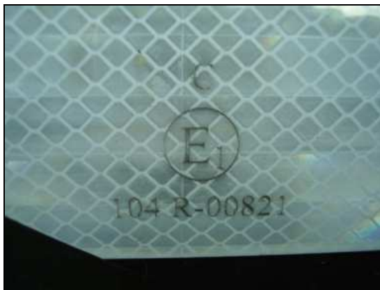
Obr. 2.: Schvaľovacia značka podľa predpisu EHK č. 104 na reflexnom páse bielej farby. Znak „C“ v hornej časti určuje, že ide o pás na vyznačenie obrysov vozidla. Materiál na nepovinné plošné nápisy a grafiku má označenie „D“ (pre použitie na obmedzených plochách) alebo „E“ (pre použitie na veľkých plochách).
